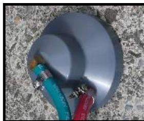
Cuando el vacío alcanza 30 mbar, se cierra la Electro-válvula 2 y el sistema neumático de la cámara interna (verde en el diagrama) queda aislado de la bomba.
